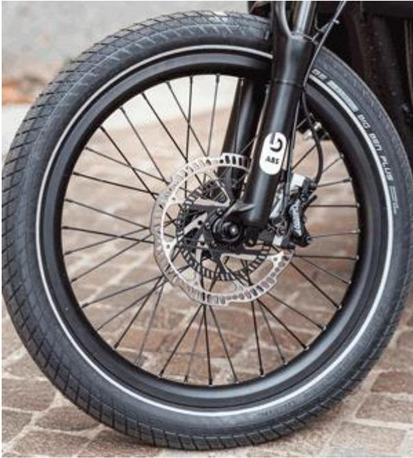
berechnen und potentiell gefährliche Situationen feststellen, die sich beim Bremsen ergeben könnten. In solchen Gefahrensituationen greift der Aktuator ein und kontrolliert den Hydraulikdruck der Vorderradbremse, was wiederum für einen gleichmäßigen Bremsvorgang und erhöhte Stabilität und Steuerbarkeit des E-Lastenrades sorgt.
